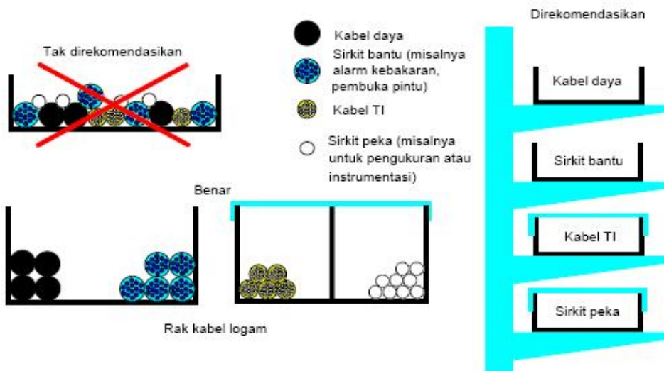
Gambar 44.R18 Pemisahan kabel pada sistem perkawatan
