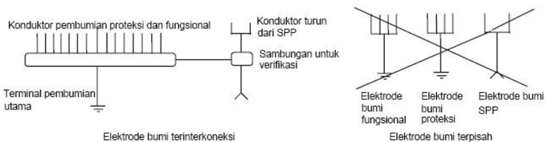
Gambar 44.R12 Elektrode bumi terinterkoneksi
